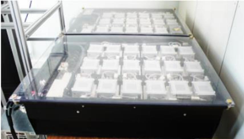
Figura 7. Supercondensadores SAFT 32F 270V.
