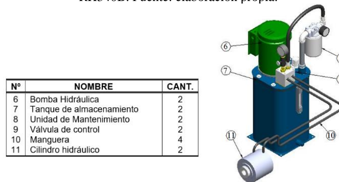
Figura 10. Vista del mecanismo de aplicación de la carga de la herramienta para el desarme de Mando Final RH340B. Fuente: elaboración propia.
